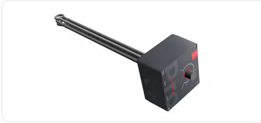
SMARTFOX Pro Heater 3K | 4,5K | 6K | 9K, RS485, 6.000W, Stand Alone Funktion, Integr. Temperatursensor
