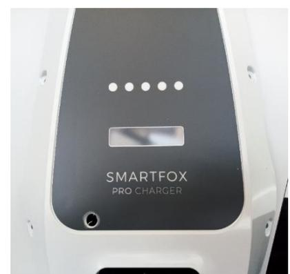
6. Die Gehäuseoberfläche in der Klebezone mit Glasreiniger reinigen und trocken lassen
